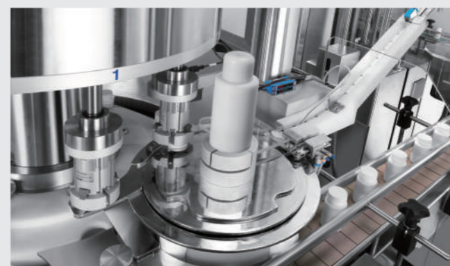
· 取蓋轉盤提供高速平穩的送蓋與取蓋。
