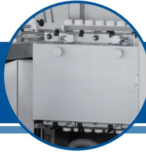
CVC 1102-400 的理瓶氣洗機，採伺服馬達及夾瓶機構，夾瓶固定後翻轉 180° 氣洗，完成後翻轉回，並傳送於輸送帶上，是瓶裝生產線達到 cGMP 要求的理想解決方案。
