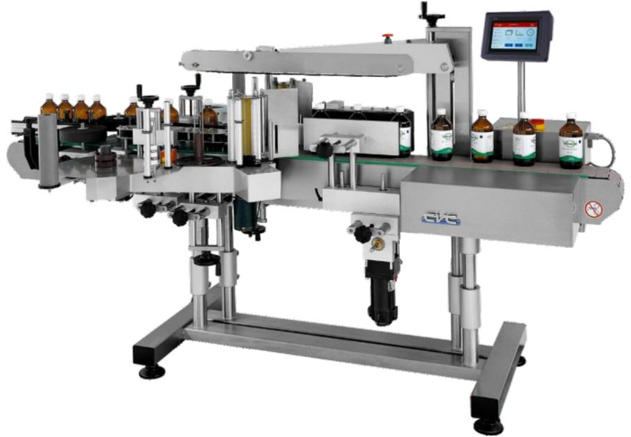
所有 CVC 貼標機皆配有我們獲得專利的 Self Set™ 自動檢測設定系統 — 不用繁瑣設定，僅需簡單一個按鍵，系統即可「全自動」感測標籤長度，及時計算並調整貼標機速度，精準貼標運作，輕鬆貼出無皺紋貼標。
