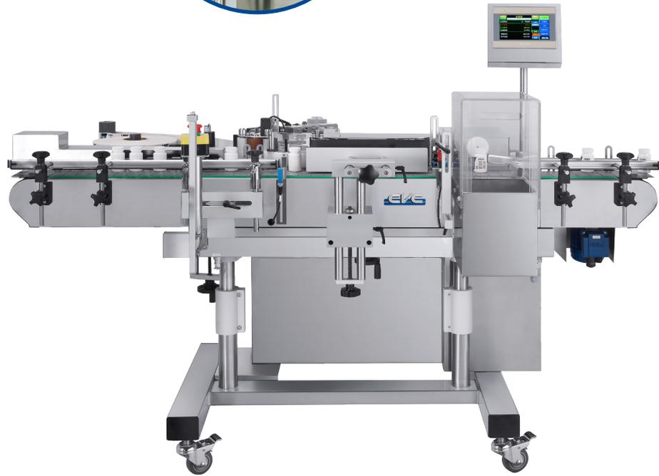
所有CVC貼標機皆配有Self Set™自動檢測設定系統 — 不用繁瑣設定，僅需簡單一個按鍵，系統即可「全自動」感測標籤長度，及時計算並調整貼標機速度，精準貼標運作，輕鬆貼出無皺紋貼標。
