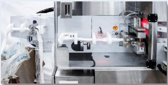
棉花經整理繞拉後進行檢測，可精準設定與裁切棉花長度，亦可搭配預拉棉系統達高速穩定。
